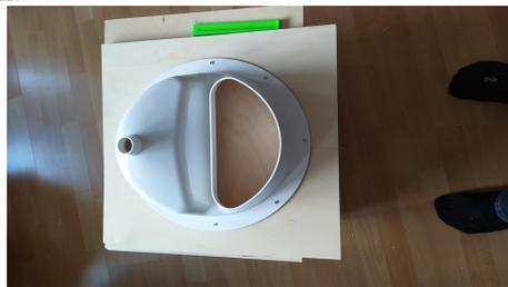
11. Boden auf die Wände legen und verschrauben nachdem die Löcher vorher am Boden angezeichnet wurden und bei Verwendung eines 3mm Bohrers im Boden vorgebohrt wurden (Schrauben 3,5x30) Ich habe mir eine Bohrschablone mit dem 3D Drucker erstellt um die Löcher im gleichen Abständen anzubringen.
