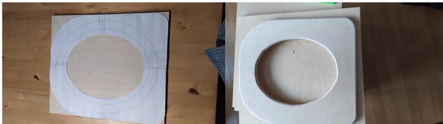
5. Die von Innen gesehen nächste Elipse ausschneiden (2. von Innen). Diese Elipse ist die Schablone für den Ausschnitt, wo der Trenneinsatz von unten gegengeschraubt wird oder von Oben eingelegt werden kann. Die Schablone so ausrichten, dass zur Aussenkontur Toilettenbrille 1,5cm frei sind.
