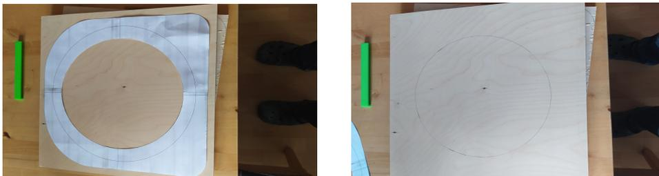
6. Optional kann die dritte Elipsenkontur verwendet werden um eine 5mm tiefe Falzfräsung in einem der Bretter vorzunehmen.
